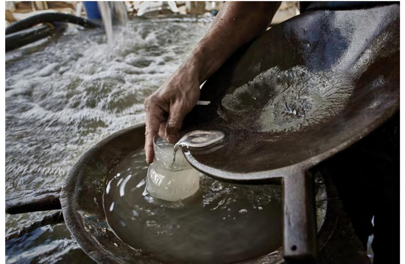
Colombia, Antioquia, vereda Carrizal, 2015. Se agrega mercurio al barro, necesario para mezclar el oro. Un elemento altamente tóxico, especialmente por el gas que emite, que pone en grave peligro la salud de los mineros. En Carrizal cada fase de extracción se realiza con las manos desnudas, sin ningún tipo de protección.
