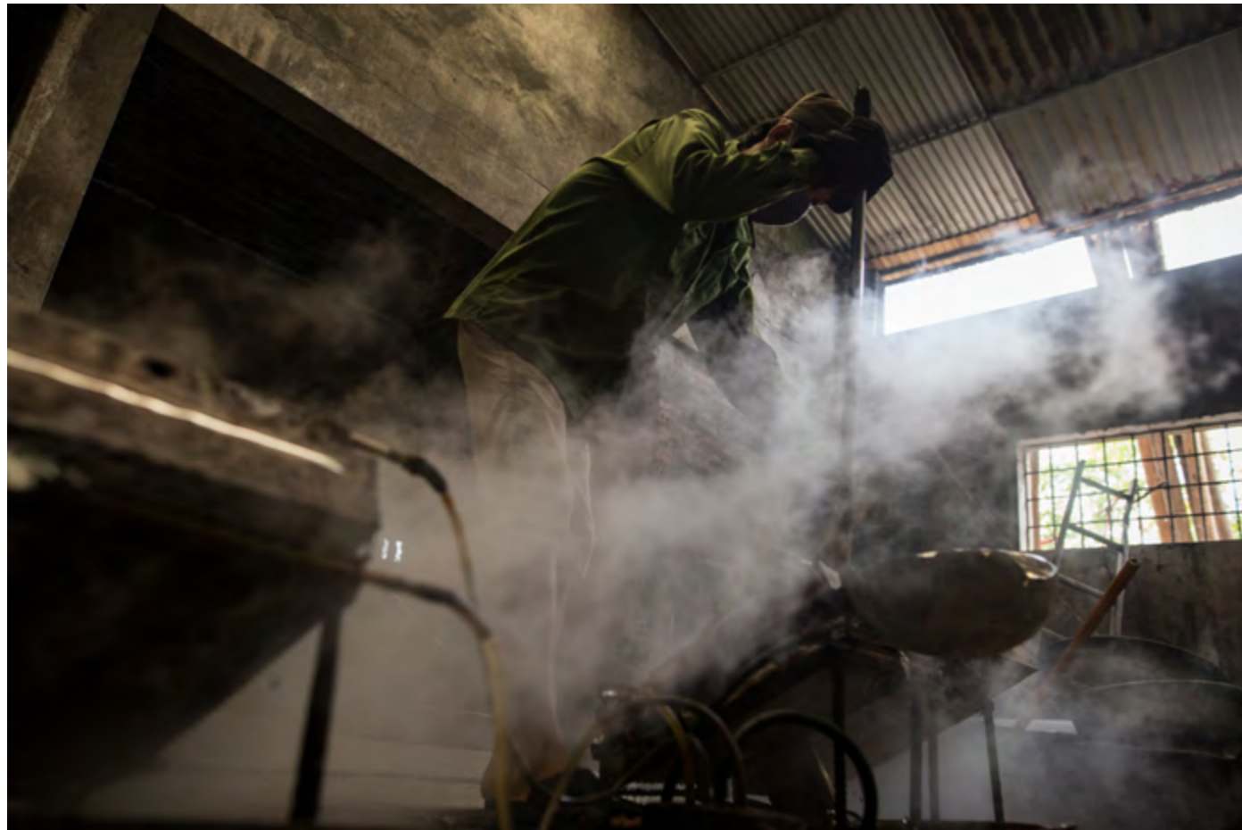
Nguyen Van Thai vierte el aluminio fundido en unos moldes con la ayuda de un cucharón. En cinco minutos, las placas de metal se habrán solidificado. Luego las colocará en el suelo para enfriarlas al aire y apilarlas en un rincón del taller.
